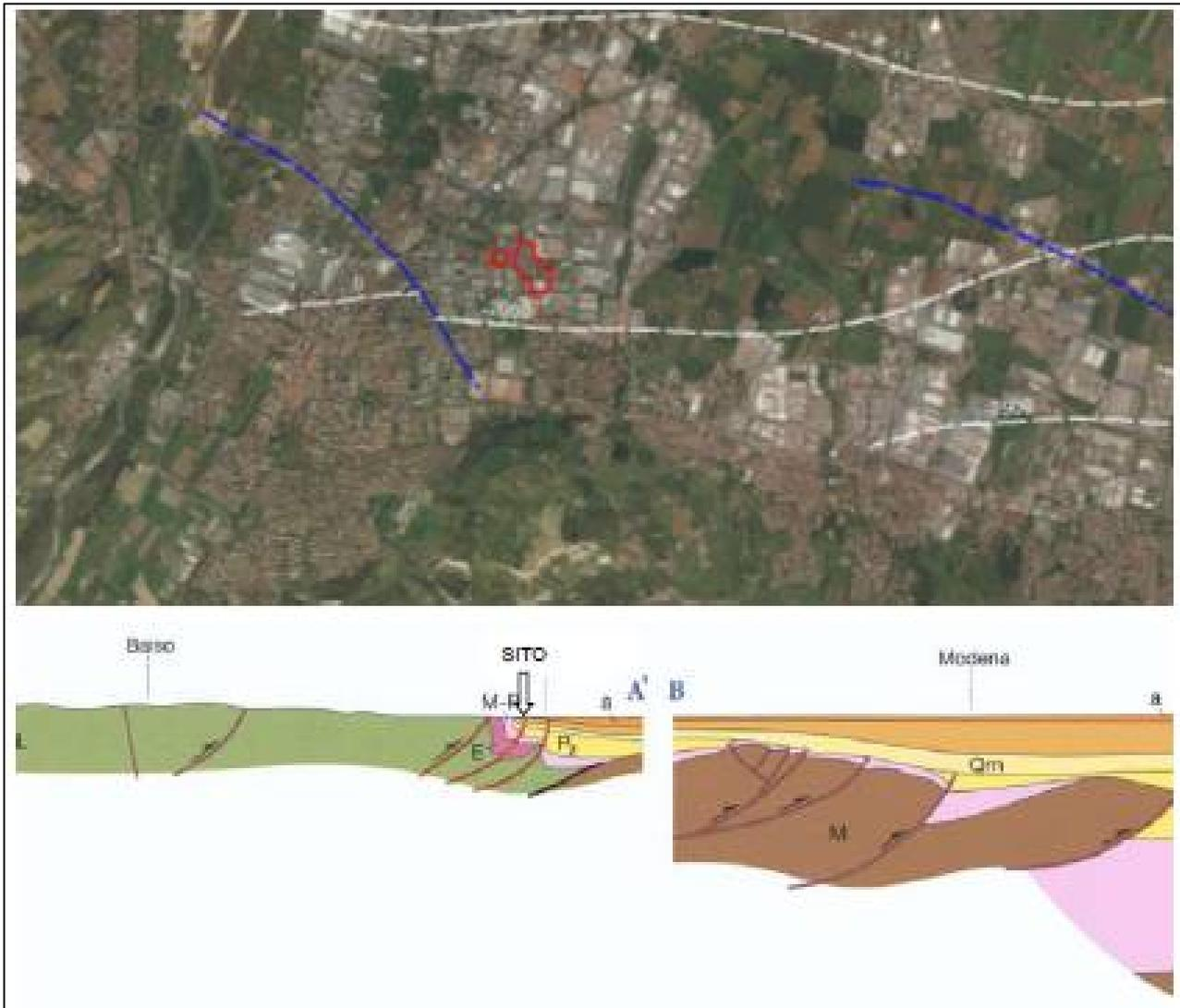
Figura 3-2 (in alto) Interpolazione dei dati geologici profondi RER relativi alla quota del substrato rigido (isolinee bianche) e la configurazione delle deformazioni del substrato rigido; (in basso) sezione geologica dell'area di interesse (Fonte: Relazione geologica Geo Group srl, 2017).
