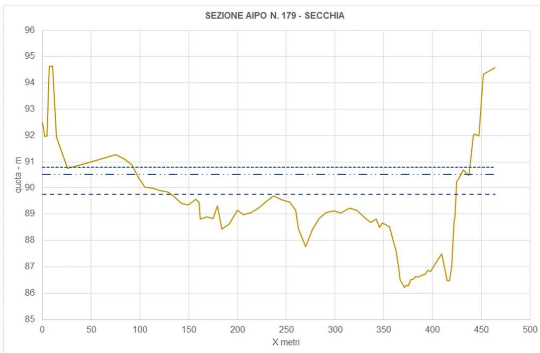
**Figura 48: sezione Fiume Secchia n. 179 – in blu i livelli per Tr 20, 200 e 500**
