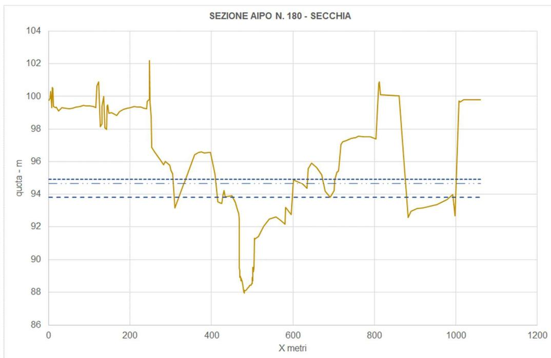
**Figura 49: sezione Fiume Secchia n. 180 – in blu i livelli per Tr 20, 200 e 500**
