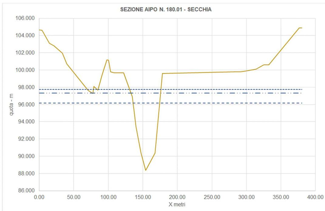
**Figura 50: sezione Fiume Secchia n. 180.01 – in blu i livelli per Tr 20, 200 e 500**
