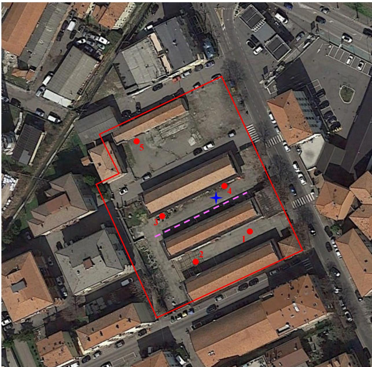
● prove penetrometriche dinamiche    - - - Indagine sismica MASW    ★ Indagine sismica HVSR
