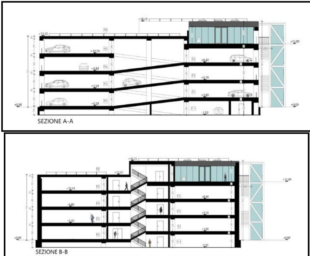
Figura 10: sezioni del fabbricato in progetto da cui si percepisce il dislivello tra i diversi piani
