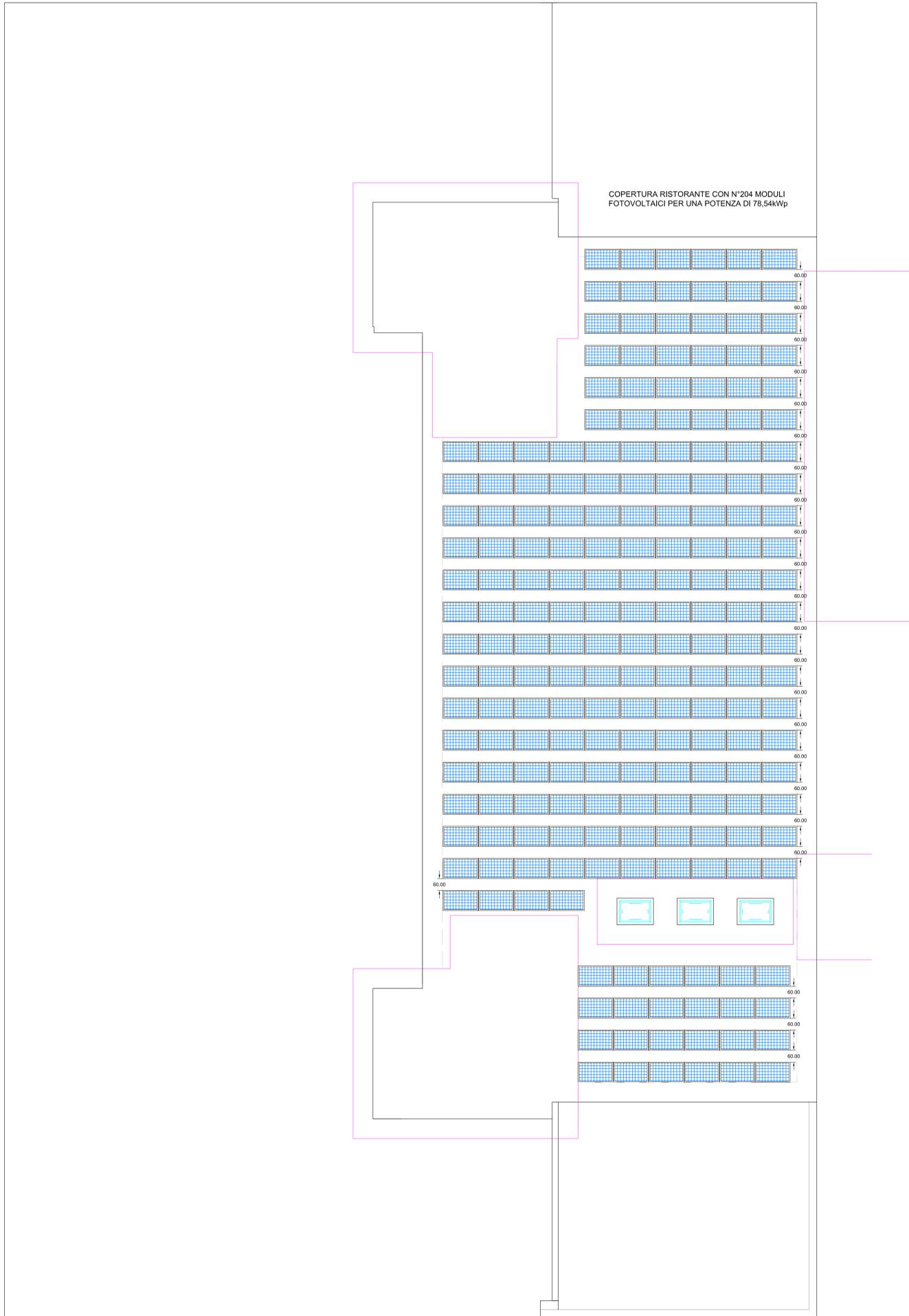
COPERTURA RISTORANTE CON N°204 MODULI FOTVOLTAICI PER UNA POTENZA DI 76,54kWp
