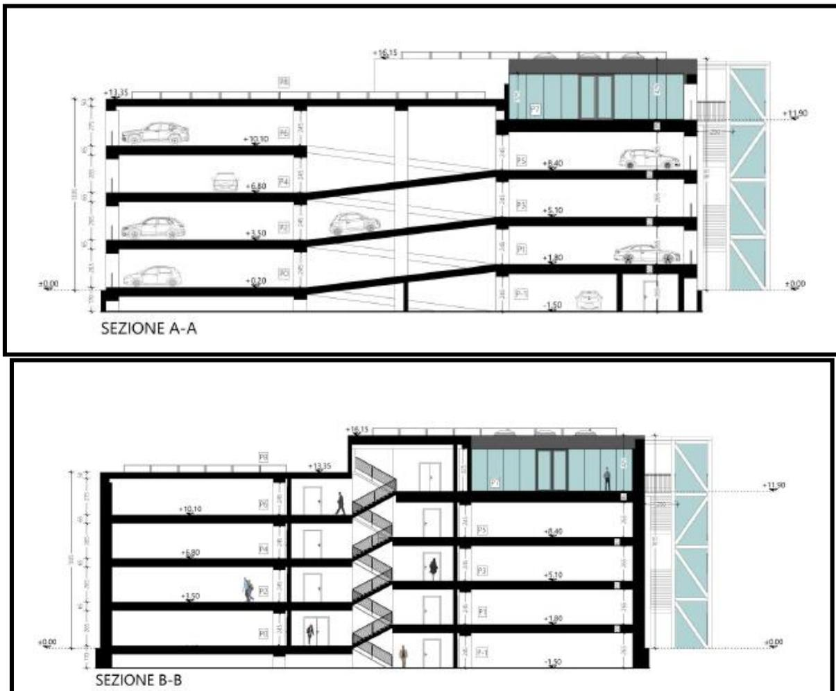
Figura 41: sezioni del fabbricato in progetto da cui si percepisce il dislivello tra i diversi piani
