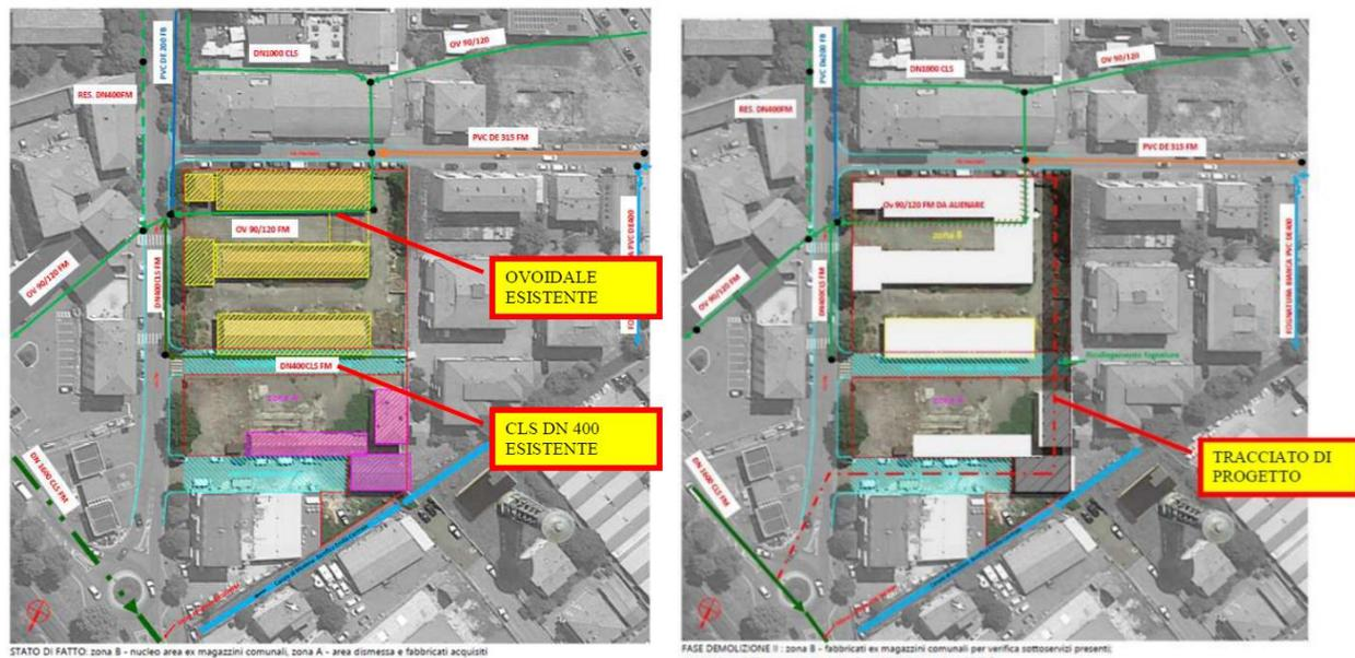
Figura 61: Stato di fatto e di progetto tratto dalla relazione di invarianza idraulica
