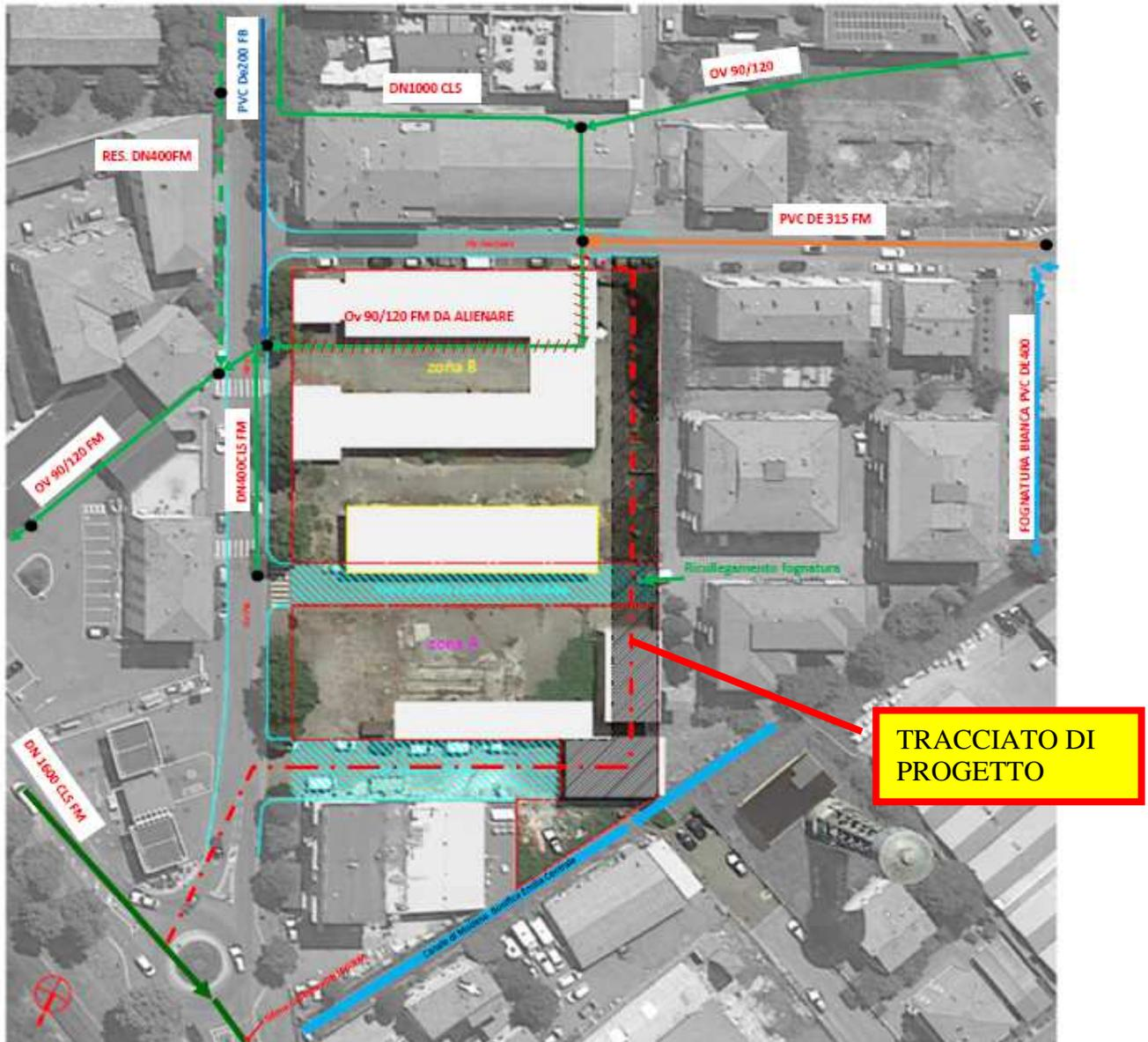
FASE DEMOLIZIONE II : zona B - fabbricati ex magazzini comunali per verifica sottoservizi presenti; sistemazione dell'area ovest per successiva realizzazione nuova viabilità.
