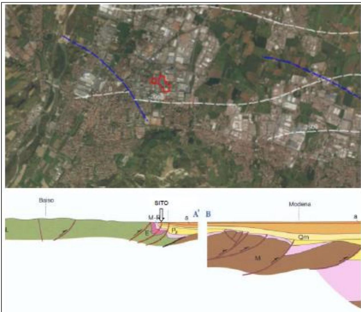
Figura 6-2 (in alto) Interpolazione dei dati geologici profondi RER relativi alla quota del substrato rigido (isolinee bianche) e la configurazione delle deformazioni del substrato rigido; (in basso) sezione geologica dell'area di interesse (Fonte: Relazione geologica Geo Group srl, 2017).
