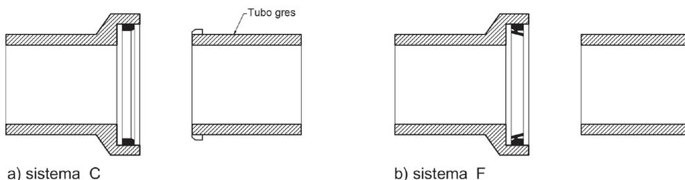
Figura 45.1. Sistemi di giunzione tubi in gres congiunto a bicchiere e guarnizione elastica (norma UNI EN 295)
