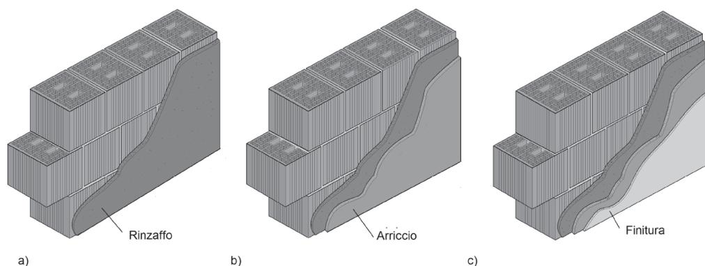
Figura 67.2. Stati componenti l'intonaco su una muratura di rompimento in laterizio
