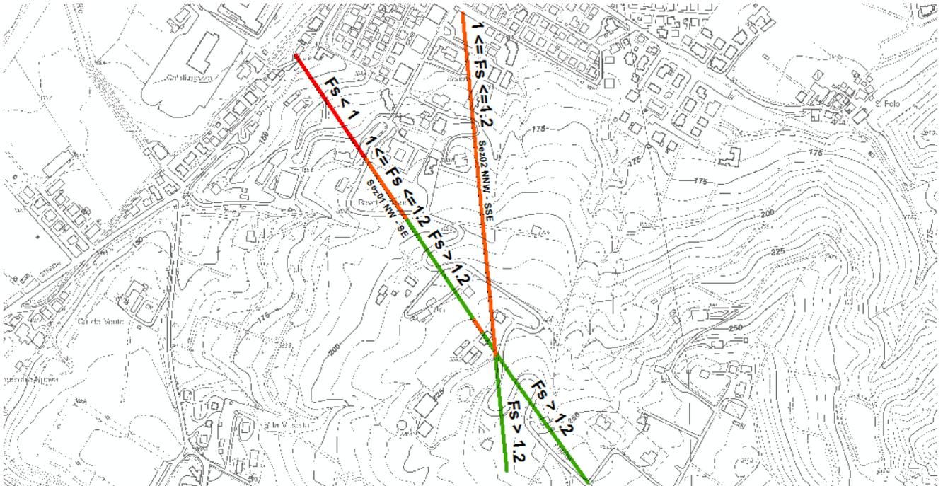
Come si evince dai risultati ottenuti, per il caso sismico, si riscontra una criticità nella parte bassa del versante lungo la Sezione 01. Su tale porzione di versante si è provveduto ad effettuare un 'analisi pseudodinamica con il metodo di Newmark al fine di quantificare gli spostamenti (in cm) in caso di sisma.
