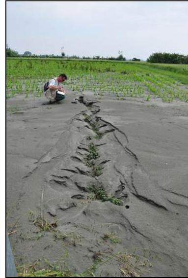
**Fig.6i: Fenomeni di liquefazione** osservati a seguito del sisma del 20.05.2012, talora associati a apertura di spaccature del terreno (foto a sx).
