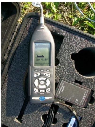
*Figura 6 – Fonometro integratore/analizzatore Real Time LARSON DAVIS modello 831*
