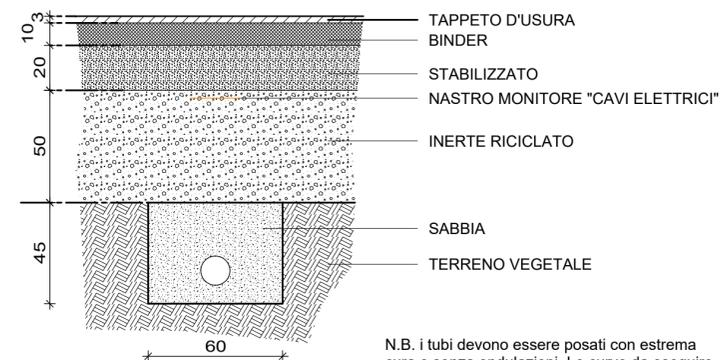
N.B. i tubi devono essere posati con estrema cura e senza ondulazioni. Le curve da eseguire esclusivamente con tubo di tipo flessibile devono avere un raggio di curvatura minimo di 1 metro. I raccordi devono essere eseguiti con gli appositi raccordi.
