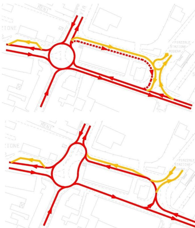
Figura 5.7 Schemi per la modifica della viabilità nel nodo stazione
