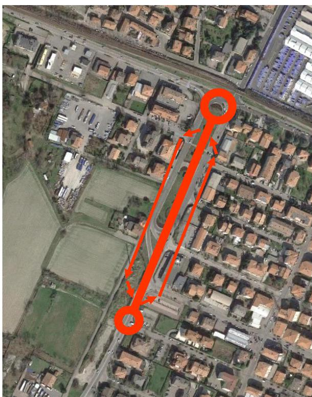
*Figura 5.3 Schema esemplificativo del funzionamento viabilistico della proposta di progetto per via Palestro*
